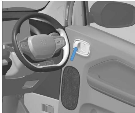
Untuk mengunci pintu depan dari dalam kendaraan, tutup pintu terlebih dahulu. Saat kecepatan melebihi 10 Km / Jam, semua pintu akan terkunci secara otomatis. Untuk membuka kunci, tarik handel pembuka pintu (tanda panah pada gambar) bagian dalam ke belakang dua kali.
