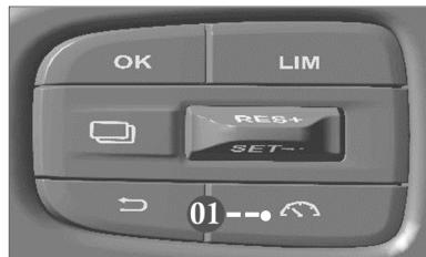
1. Pada saat kendaraan melaju dengan posisi gear S (30-100) Km / jam atau Posisi gear D (30-85) Km / jam). Tekan tombol cruise control di sisi kiri roda kemudi , maka sistem cruise control memasuki kondisi siaga, dan lampu indikator cruise control pada instrumen gabungan akan berkedip.
