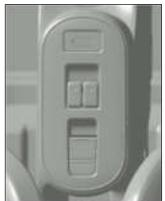
1. Tombol power window dapat mengontrol pembukaan dan penutupan jendela. Karena jendela kendaraan ini tidak dilengkapi dengan fungsi Anti Terjepit, sebelum mengoperasikan power window, pastikan tidak ada benda asing di bingkai jendela.
